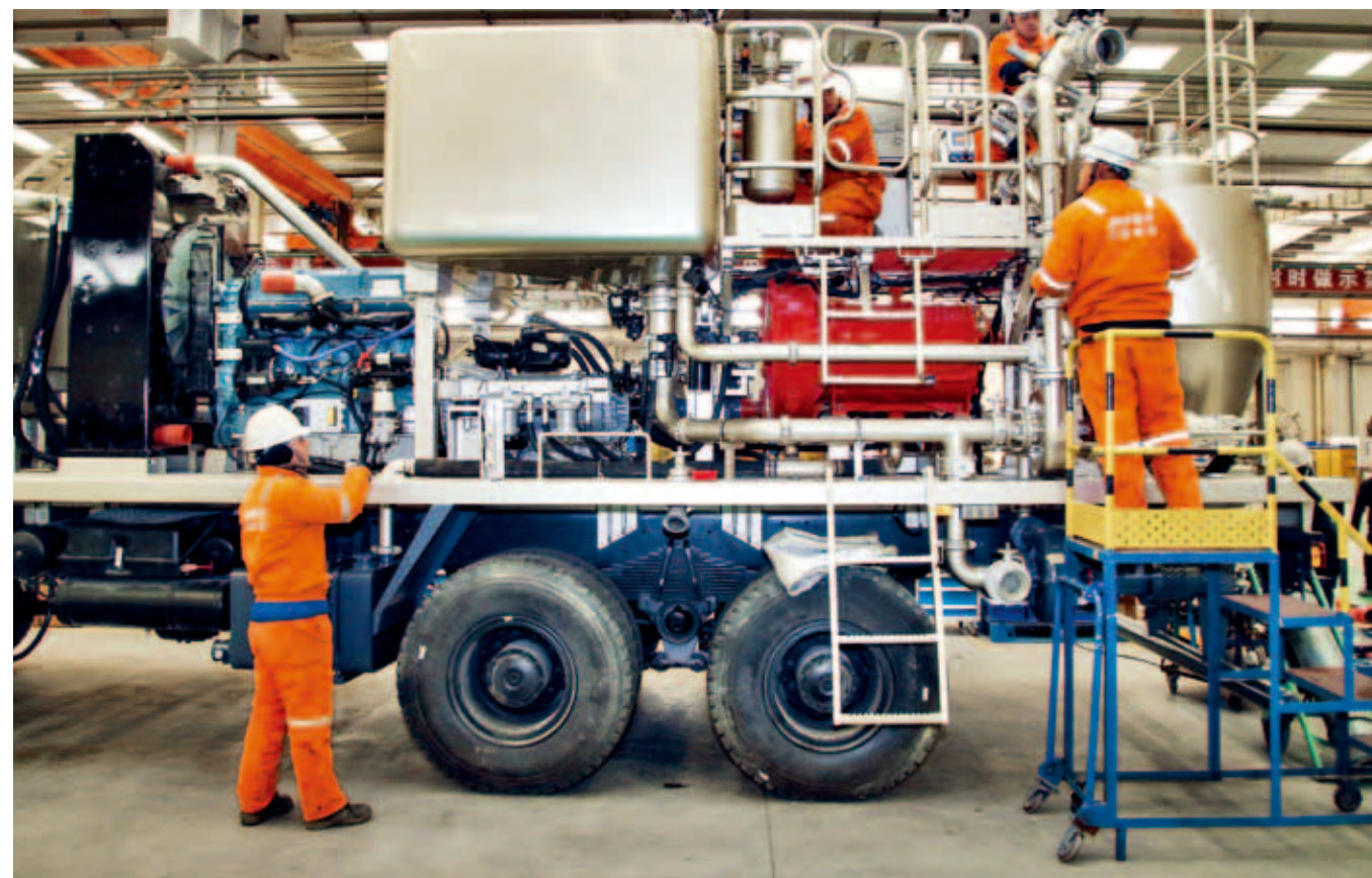
烟台杰瑞石油公司的工人们正在制造固井车。图 / 视觉中国
